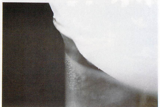
写真10 雨粒のでき方「実験I」による約1cmの透明部(乾燥部)
