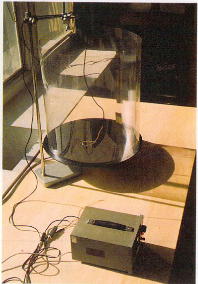
写真8 地面の暖まりやすさの違いによる気圧差の発生 (プラスチック円筒を置いた場合)
