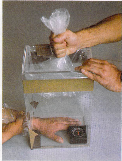
写真6 断熱膨張による温度変化の体感
