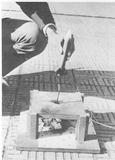
写真2 ロケット点火装置と発射台(木製) ロケットは点火装置をかぶせるよ うに垂直におく。
