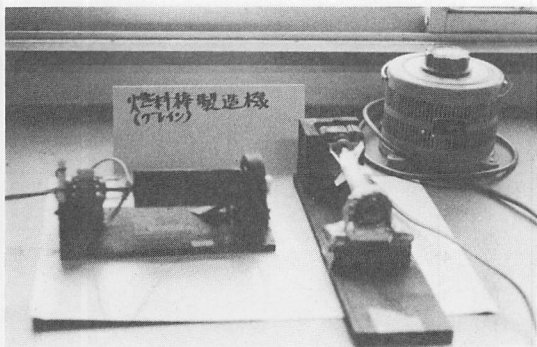
写真1 グレイン製造機(小型交流モーターとローラーベアリングで製作)
