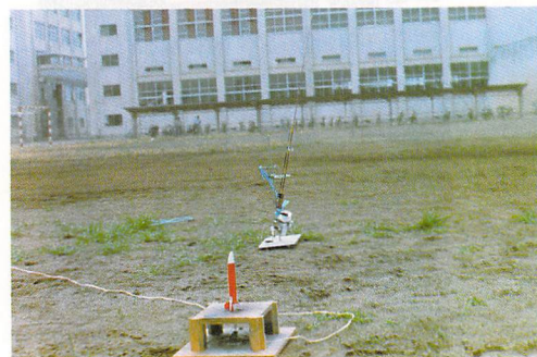
写真16 つり糸牽引ロケット、向こう側のつりざおのつり糸を ロケットが牽引
