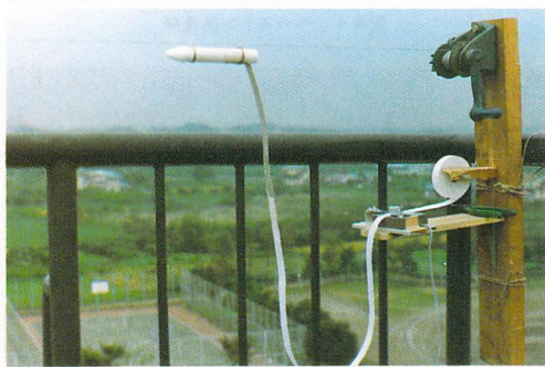
写真14 屋上にセットした針金滑走ロケット記録タイマーを 用いて加速度測定
