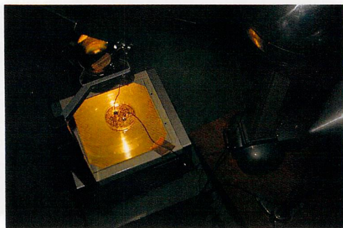
写真2 電界の単元：作業と併用して、電気力線を直接観察させる、ヴァン・デ・グラフ起電機を用いて高電圧をかけ、花の種子による電気力線を OHP で投影する。
