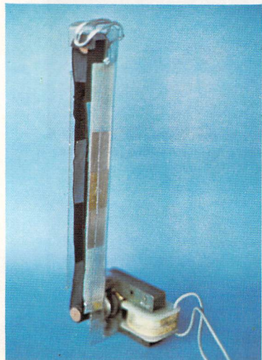
写真19. 電動発振器 ナイロンとテトロンベルトを回し て発振するとパルス密度の高い電波 が得られる。
