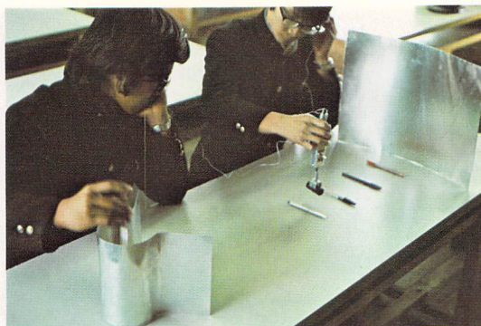
写真14. 磁界の定常波 磁界アンテナでしらべると、電界の節が 磁界の腹になっていることが見つかる。
