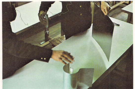
写真15. 反射の法則 発振器と磁界アンテナを一定位置に置き、反射板 を動かして反射の法則をたしかめる。
