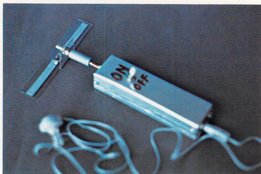
写真6. 電界アンテナ \frac{\lambda}{2} のダブルツェットアンテナをプリアンプに取り付けてイヤホンで聞く。
