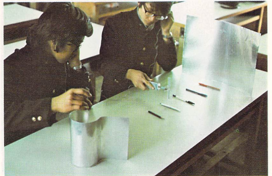
写真13. 電界の定常波 反射板の前に定常波を作り、電界の節の 位置に目標物を置く。
