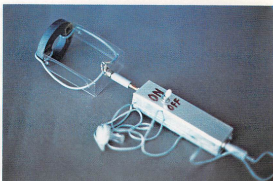
写真9. 環状磁界アンテナ 環状コアの対向点にコイルを1回づつ巻いて並列にしたもので、電束電流による磁界を確かめる。
