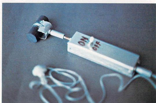
写真7. 磁界アンテナ 直径2.2cmのフェライトコアにダイオードを巻き付けたバーアンテナ。
