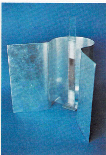
写真4. 指向性共振器 この共振器により、鋭い指向性を与え、パルスを長くする。
