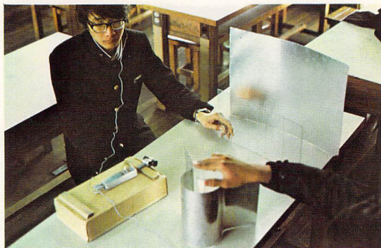
写真16. 2枚の反射板による干渉 半透反射板を用いると光の薄膜による干渉 に相当する実験ができる。
