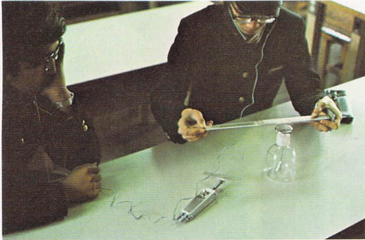
写真10. 発振器の原理 電極板の近くの電界の様子を検電器でし らべる。
