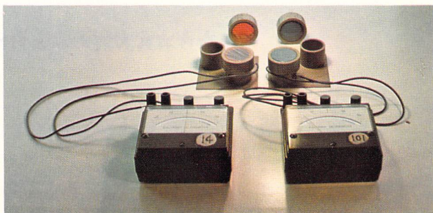
写真4. 色光をあてて、増幅つき検流計で起電力 を測る。赤い光では起電力が全く生じな い。他の色光なら光の強さに応じ起電力 を生ずる。
