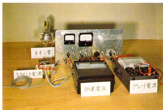
写真7. 実験装置 ネオン管をとりつけたところ
