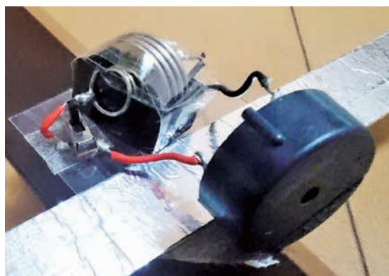
写真2 滑走体に乗せたブザー・電池部分
