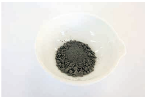
写真3 焼成後の銅廃液処理剤
