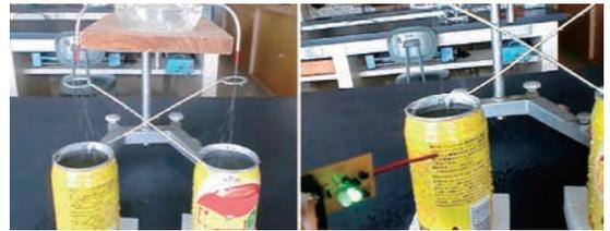
写真5 ケルビン発電機の帯電の様子
