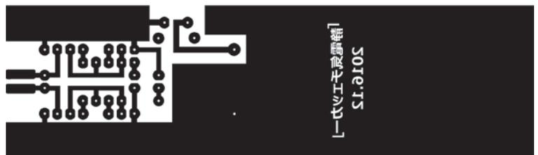
図2 プリント基板パターン図（原寸大）
