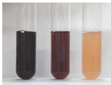
写真3 三種類のメチルエステルによる呈色 左からブタン酸メチル、オクタン酸メチル、 ドデカン酸メチル
