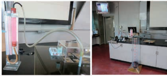
写真 6 ふたに接続した気圧計とモニタへの投影
