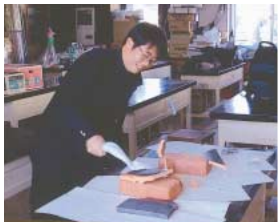
写真9 瓦に非弾性ボールをぶつける
