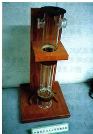
写真8 中谷先生の装置 (1936年に世界初の人工雪が作成された)
