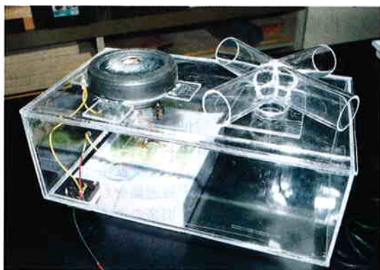
写真3 排気ホースの口径を大きくしたため全て作り直したアクリル製新型空気溜め
