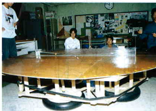
写真8 回転する長尺水槽の放物水面を観察 (水槽の水に働く重力と遠心力の 合力により水面が放物面になる)
