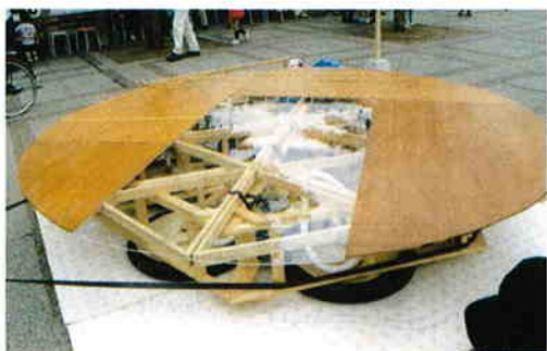
写真7 組み立てが完成した大型回転台 (内部の構造がよく分かるように天板の 一枚はアクリル製にしてある)
