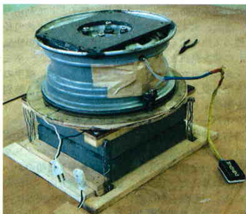
写真5 車のホイールを利用した中心軸回転装置 (古掃除機のモーターの固体ブラシを 利用した回転接点がアイデア)
