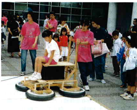
写真4 新型ホバークラフト（科学の祭典会場にて） （空気溜めはプラスチック製にして強度を保った祭典用タイプである）
