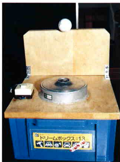
写真1 旧型空気溜め (強力な空気圧のため、ゴルフボールも浮き上がる)
