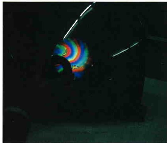
写真5 ブラウン管前面に磁石を近付ける
