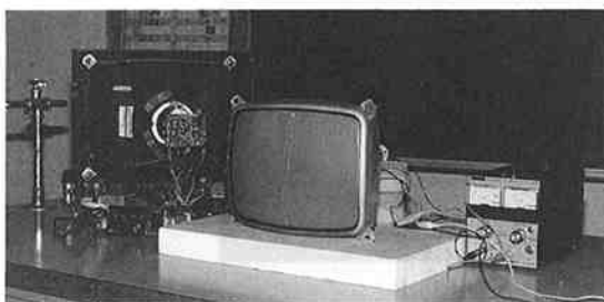
写真11 偏向コイル AB、CD に交流を流す
