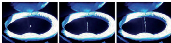
図 13 トラップ電圧を徐々に大きくしたときのトラップされた粒子の軌道
