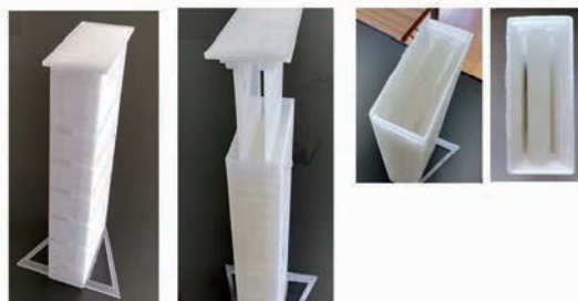
写真1 挿入板を引き抜き、穴の開いたゲルをつくる
