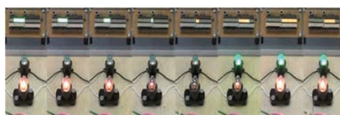
写真 4 電球と LED の交流電圧での点灯比較
