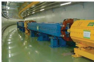
5.0 GeVシンクロトロン (周長1600m) : 平成20年5月22日に3 GeVビーム周回、RF捕獲、出射に成功。
