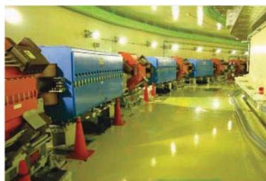
3 GeVシンクロトロン (周長350m) : 平成19年10月31日にビーム。平成20年2月末にはパルスあたり5 kW (2.5 Hzでは130 kW相当)。同年9月18日には210 kW 出射。
