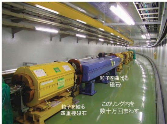
図5 シンクロトロン の原理と実際のシンクロトロン。
